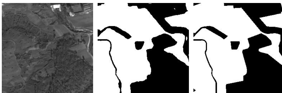
图 8-2 标签弱化问题 左至右依次为遥感图、预测标签、人工标签
