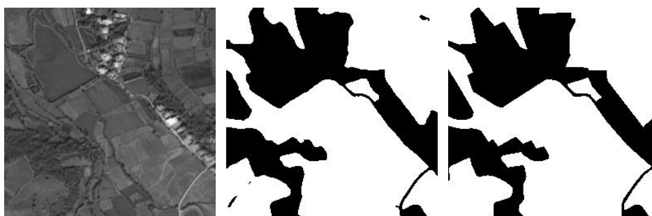
图 8-1 标签弱化问题 左至右依次为遥感图、预测标签、人工标签
